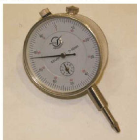
Micrometro con dial rango 0-10mm, sensibilidad 0.01mm
