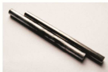
Varillas de aluminio y acero inoxidable para expansión lineal térmica
