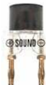
Altavoz (zumbador piezoeléctrico)
